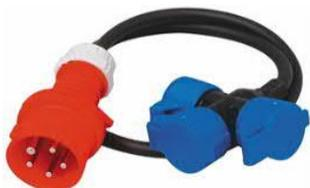
2428404 Mehrfachsteckdosenadapter mit 1m Verbindungskabel 5G1,5qmm, 5x16-Stecker-in. 3 Schuko Steckdosen-out, mit selbstschl. Deckel, jew. auf 1 Phase verkabelt
